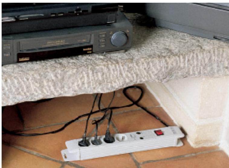
**Certains prolongateurs multiprises sont conçus pour protéger les équipements électroniques fragiles et coûteux (ordinateurs, téléviseurs, appareils vidéo et audio...).**
